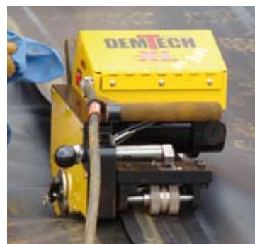
Il existe communément deux types de soudures pour ces géomembranes : l'extrusion au polyéthylène et la soudure par fusion.
